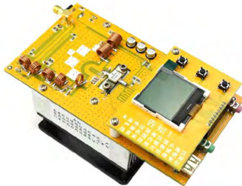
Fig. Un des deux émetteurs dont il est question ici, d'une puissance de 30 W.
