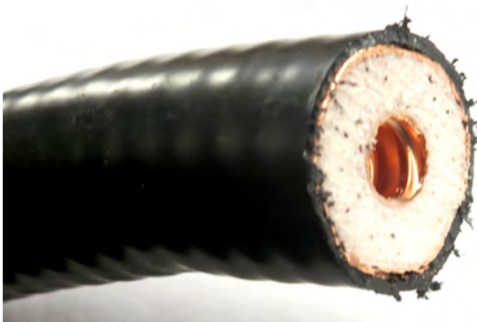
Fig. Câble coaxial haut rendement et puissances élevées. Diamètre extérieur 50 mm, âme creuse, diamètre âme 18 mm.
