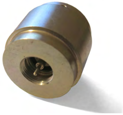
Fig. Une très petite charge fictive, prise N mâle, à fixer à la sortie de l'émetteur.
