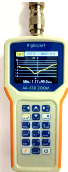
Fig. Un analyseur d'antenne montrant l'évolution du TOS provoqué par une antenne en fonction de la fréquence utilisée. L'antenne analysée ici sera optimale à la fréquence de 99,0 MHz.
