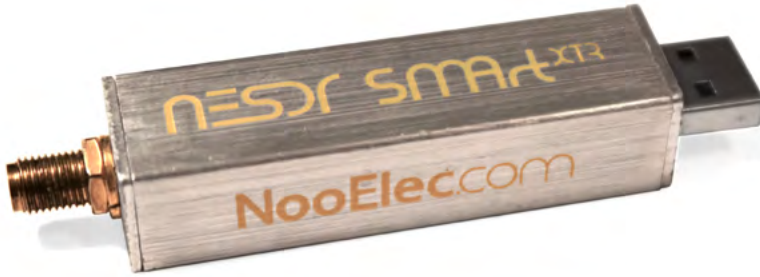
Fig. Une clé SDR NooElec (connecteur SMA à gauche, USB à droite).
