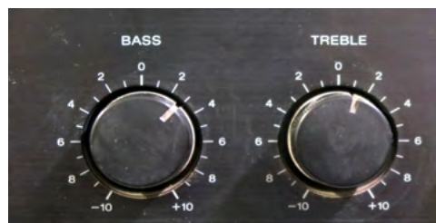
Fig. Un égaliseur sommaire deux bandes sur un amplificateur Hi-Fi.
