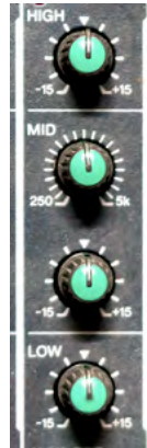
Fig. Un égaliseur semi-paramétrique trois bandes sur une tranche de table de mixage.
