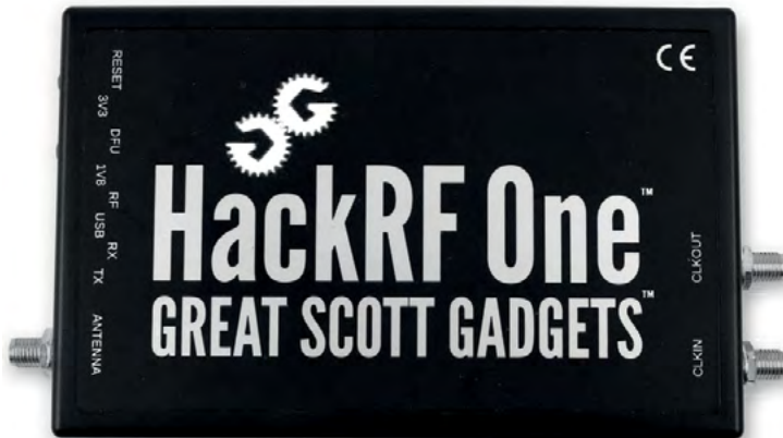
Fig. Un HackRF One , périphérique SDR pouvant servir de modulateur DAB+.
