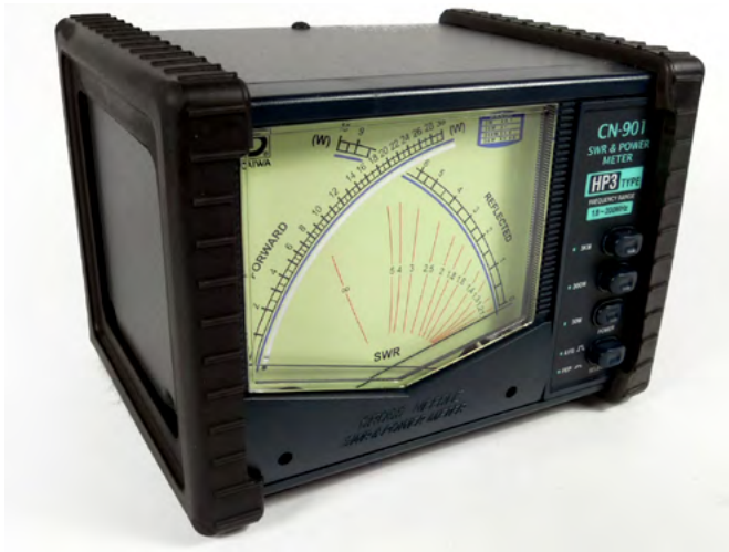
Fig. Un TOS-mètre Daiwa CN-901, capable d'afficher les puissances incidentes et réfléchies. L'intersection des deux aiguilles indique la valeur du TOS.
