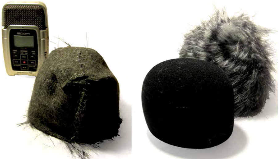
Fig. Une sur-bonnette DIY. À gauche l'enregistreur et l'envers de la sur-bonnette. À droite la bonnette mousse et l'endroit de la sur-bonnette.
