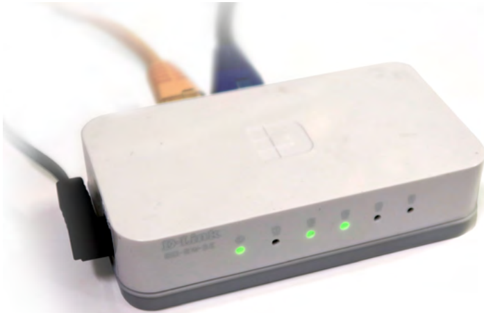
Fig. Un petit switch GO-SW-5E de la marque D-Link, à quatre ports.
