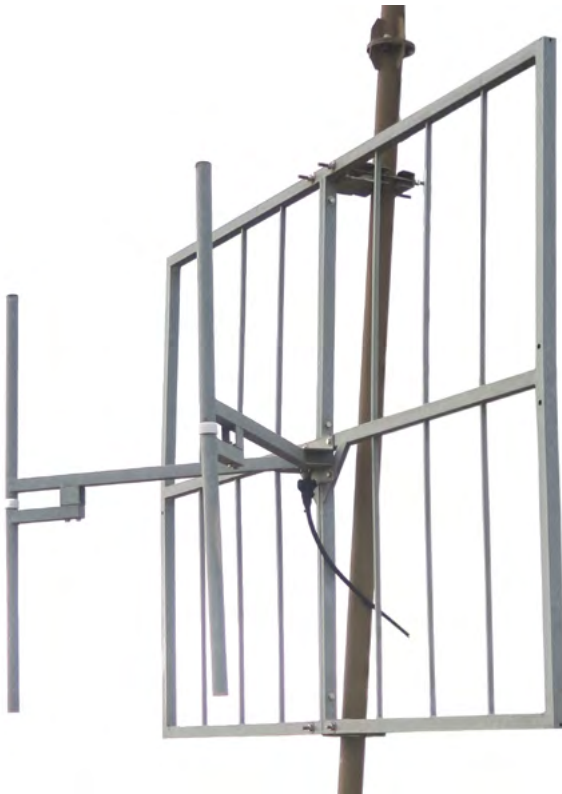
Fig. Une antenne panneau et double dipôle sur mât.
