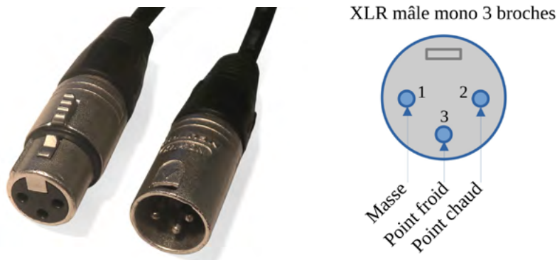
Fig. Deux connecteurs XLR (femelle à gauche, mâle à droite), et le schéma des trois broches d'un connecteur XLR mâle vu de face.
