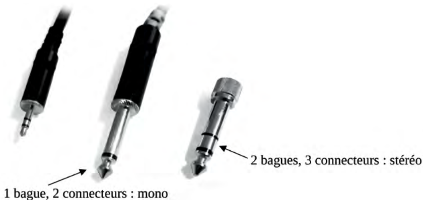
Fig. De gauche à droite : un jack stéréo 3,5 mm (« mini »), un jack mono 6,35 (« gros »), et un adaptateur mini-jack vers gros jack stéréo.
